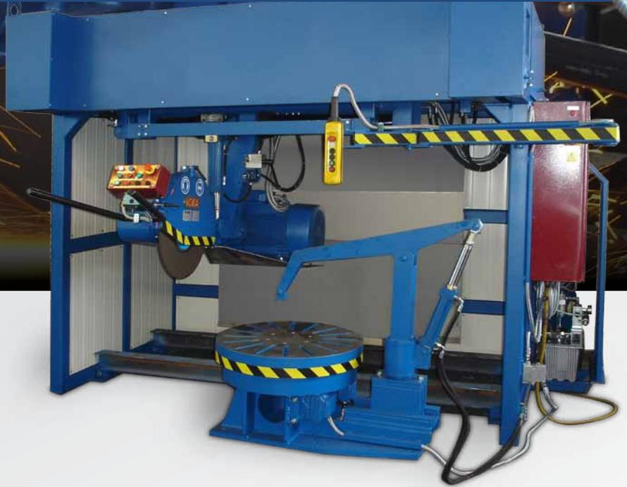
Die Gießerei-Trenneinheit der Type GTE ist der perfekte Kompromiss einer handbedienbaren Pendeltrennmaschine und einer stationären Trennanlage. Die Maschineneinheit kann ohne besondere Maßnahmen an jedem Einsatzort leicht installiert werden. Eine allseitige Beweglichkeit und eine einfache Handhabung ermöglichen ein schnelles und problemloses Einrichten der Trennscheibe am Gussstück.
