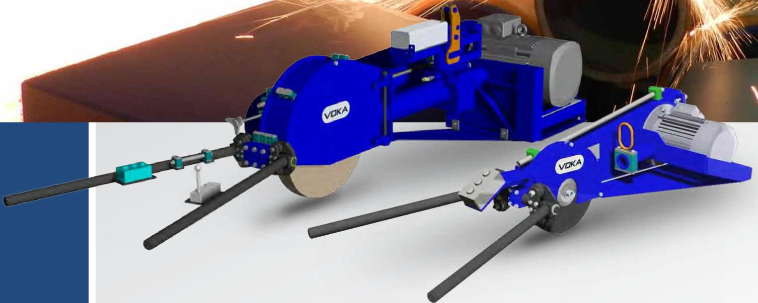
Die Pendelschleifmaschinen der Baureihen KPS und ZPS sind bestens für das Grobschleifen an mittleren und schweren Gussstücken geeignet. Durch die sehr robuste und gießereigerechte Bauweise ist ein störungsfreier Dauerbetrieb mit geringem Wartungsaufwand garantiert. Die Kraftübertragung vom Motor zur Schleifscheibe erfolgt wahlweise mittels Kardantrieb (KPS) oder Hochleistungszahnriemen (ZPS).
