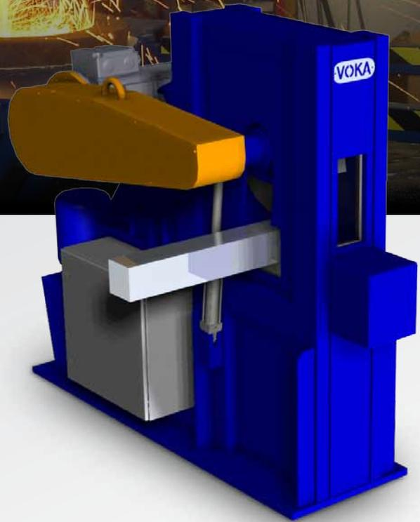
Unsere Hochleistungstrennmaschinen sind bestens für das Trennen von Stangen, Knüppeln und Profilen aller Materialqualitäten einschließlich hoch- und höchstlegierter Stähle geeignet. Die Maschinen dieser Bauserie wurden hauptsächlich für den Einsatz in der stahlverarbeitenden Industrie entwickelt. Sie arbeiten im Kappschnitt und werden zum Trennen kleinerer und mittlerer Querschnitte von Stangen und Profilmaterial eingesetzt.
