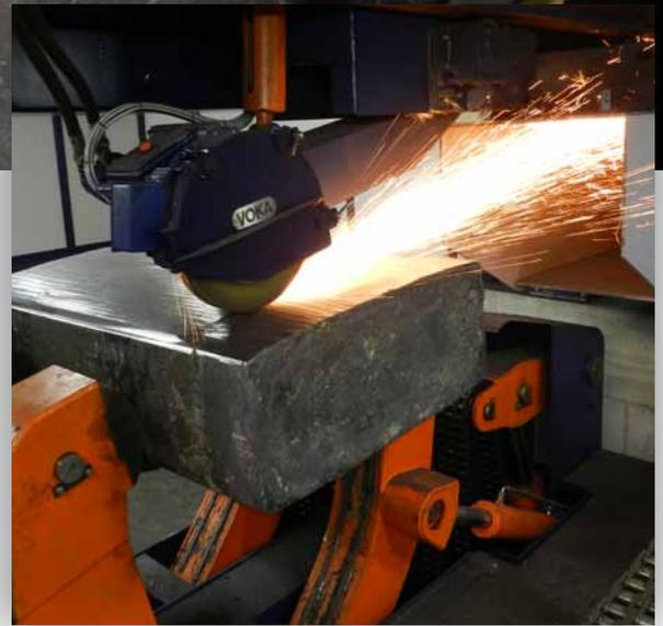
Knüppel- und Blockschleifanlagen eignen sich hervorragend zur Entfernung der Zunderschicht von gegossenen oder geschmiedeten Blöcken. Die VOKA- Blockschleifanlagen dienen ebenso zum manuellen als auch teilautomatisierten Schleifen der Oberfläche von Flachmaterial sowie zum manuellen Ausschleifen von Fehlerstellen an der Oberfläche von runden, rechteckigen und polygonalen Blöcken.
