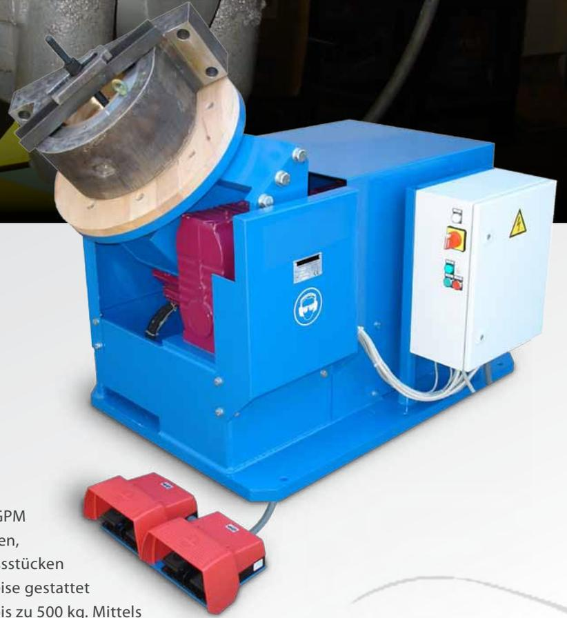
Die Gussputzmanipulatoren der Type GPM ermöglichen Ihnen das Spannen, Drehen, Schwenken und Positionieren von Gussstücken beim Putzvorgang. Die robuste Bauweise gestattet die Bearbeitung von Stückgewichten bis zu 500 kg. Mittels Fußtaster wird ein Getriebemotor, verantwortlich für die Dreh- und Kippbewegungen, angesteuert. Die Spannung der Werkstücke erfolgt hydraulisch und garantiert höchste Sicherheit.
