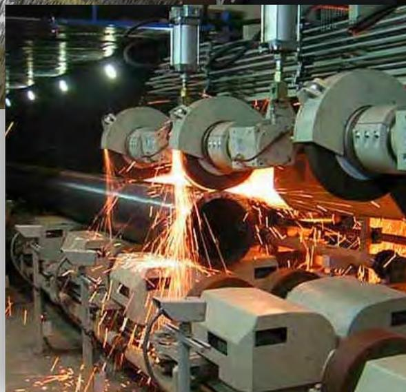
Unsere Rohrschleifmaschinen sind ideal zur Vorbehandlung von gewalzten, geschmiedeten, gezogenen dickwandigen Rohren. Die Oberfläche wird für eine nachfolgende mechanische Bearbeitung vorgeschliffen.
